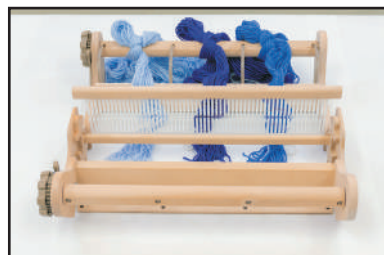
⑤ バックローラーを手前にし、ヘドルを レストポジションに置きます。 糸端は軽くフロントローラーに結んで おきます。
